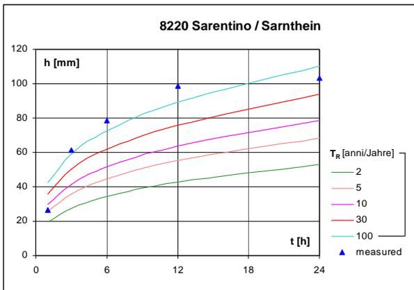
**Figure 27/28.** Curve segnalatrici di probabilità pluviometrica per le stazioni Sarentino e Selva dei Molini a diversi tempi di ritorno (anni), e valori di precipitazione massima osservati alla stazione per le durate di 1, 3, 6, 12 e 24 ore consecutive durante l'evento di piena (triangoli).
