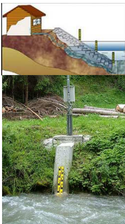
Figure 1/ 2/3. Idrometrografo pneumatico sul rio San Vigilio a Longega (Fig.1), sistema meccanico a galleggiante sul torrente Aurino a Cadipietra (Fig. 2) e sensore ad ultrasuoni sull'Isarco a Bressanone (Fig. 3).
