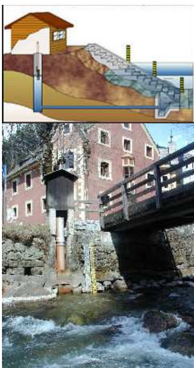
Figure 1/ 2/3. Idrometrografo pneumatico sul rio San Vigilio a Longega (Fig.1), sistema meccanico a galleggiante sul torrente Aurino a Cadipietra (Fig. 2) e sensore ad ultrasuoni sull'Isarco a Bressanone (Fig. 3).
