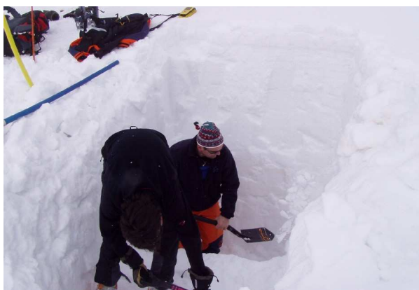
Figure 1/2. Campagna invernale (3 maggio 2004) con trincea per il rilievo del profilo stratigrafico e della densità della neve (a sinistra) e panoramica estiva del ghiacciaio di Fontana Bianca, 27 agosto 2004 (a destra).
