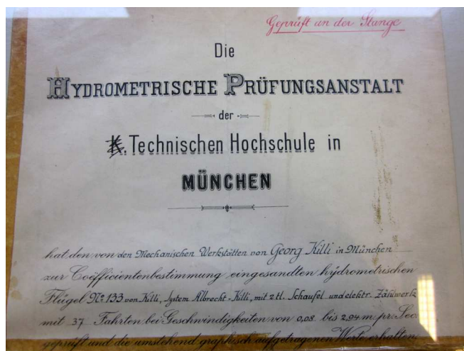
Fig. 1. e 2. Mulinello idrometrico officina meccanica Killi, Monaco di Baviera (a sinistra) e protocollo di calibrazione TH München (a destra).
