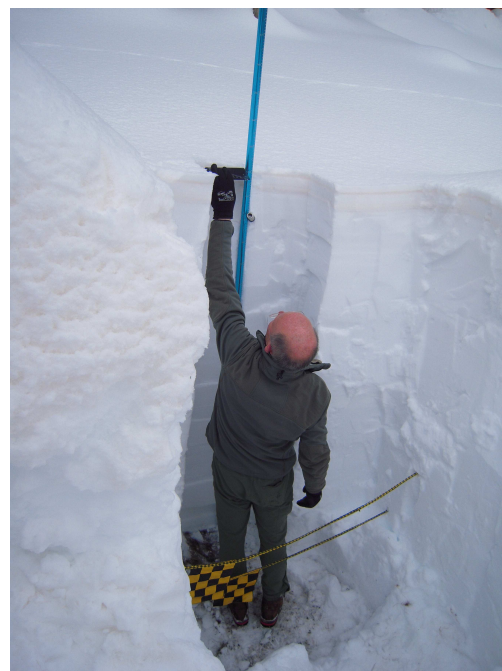
Immagine a sinistra: precipitazioni cumulate tra dicembre 2013 e febbraio 2014 (inverno meteorologico). Immagine a destra: profilo della neve il giorno 20 febbraio a Fontana Bianca (Val d'Ultimo). L'altezza della neve al suolo era di 2.2 m e negli strati superiori si riconosce la sabbia del Sahara.
